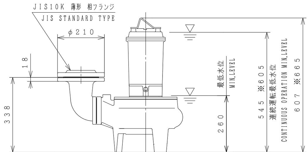
※は、M・T・P (マイクロサーマルプロテクタ) 取り付け時の寸法です。
