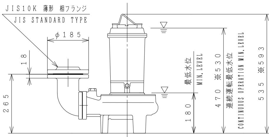
※は、M・T・P (マイクロサーマルプロテクタ) 取り付け時の寸法です。
