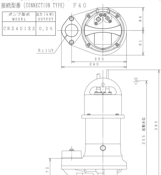
(注) ポンプは水位が起動水位になると運転を開始します。 水位が起動水位以下に下がると12~60秒後に運転を停止します。 本機を槽内に2台設置した場合は、2台で交互運転をします。
