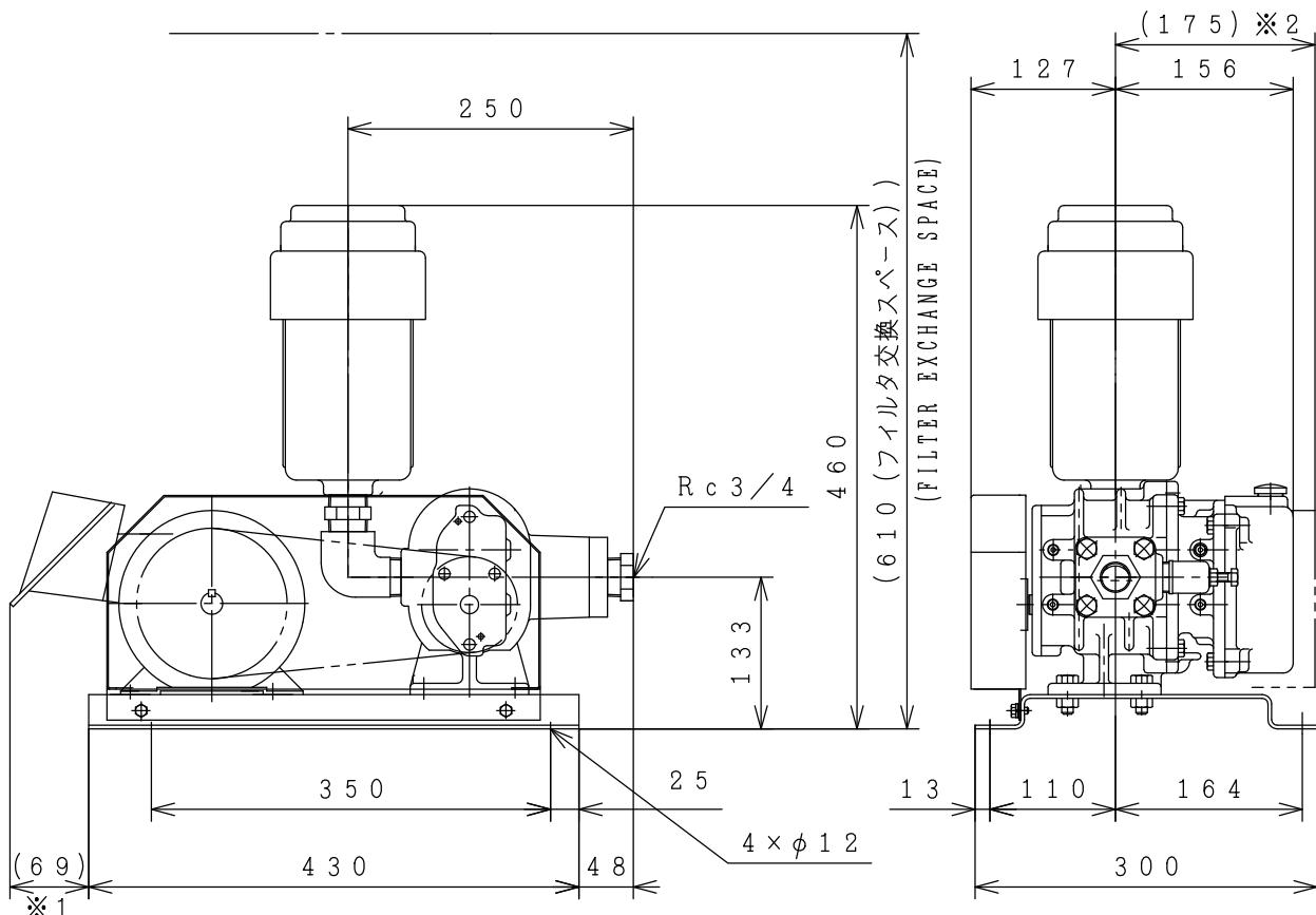
1. ※1、※2寸法は標準の最大モータを搭載した場合の、機器としての最大寸法です。
