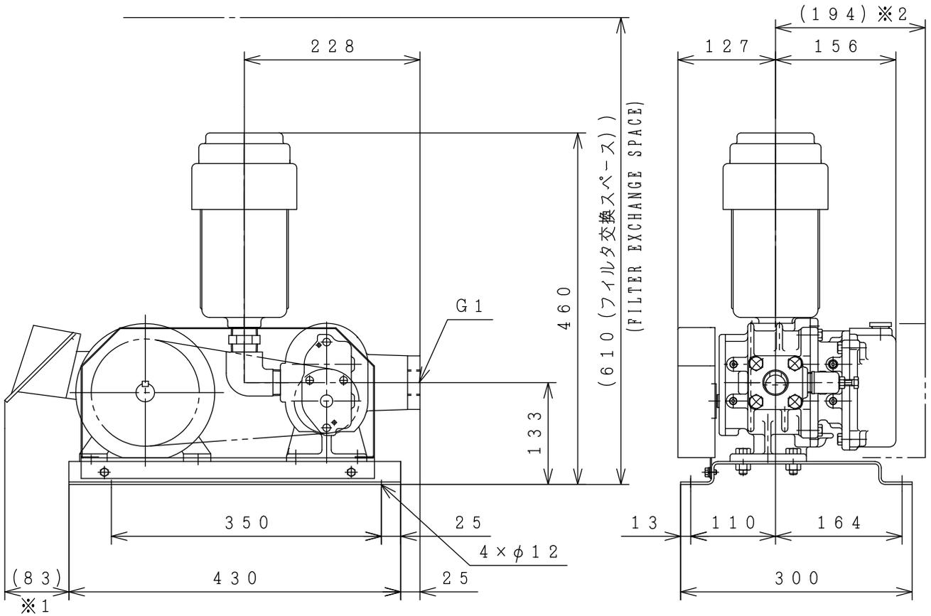
1. ※1、※2寸法は標準の最大モータを搭載した場合の、機器としての最大寸法です。
