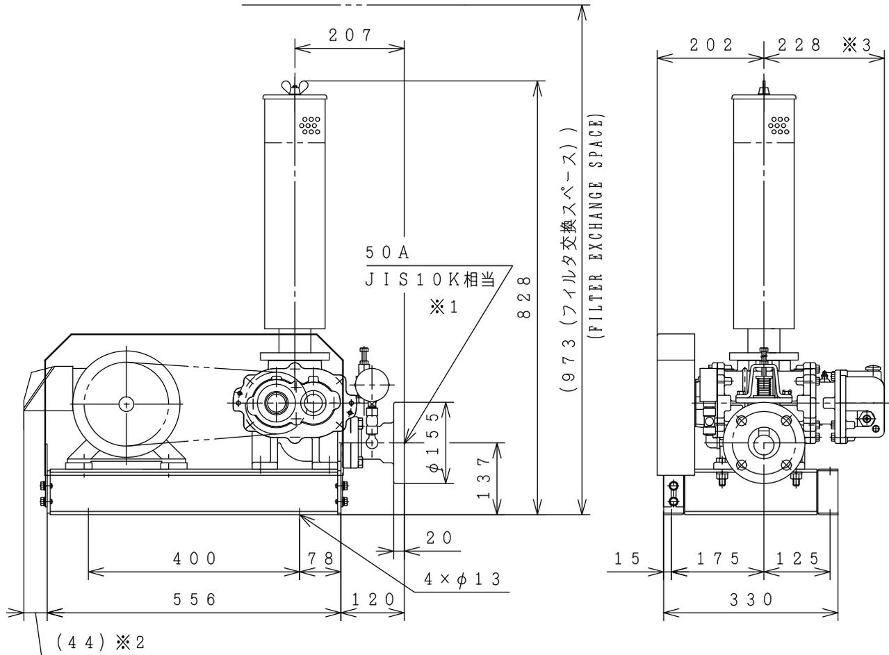
1. 吐出部フランジ (※1) の穴ピッチ、ボルト穴径は JIS 10K にあわせています。
