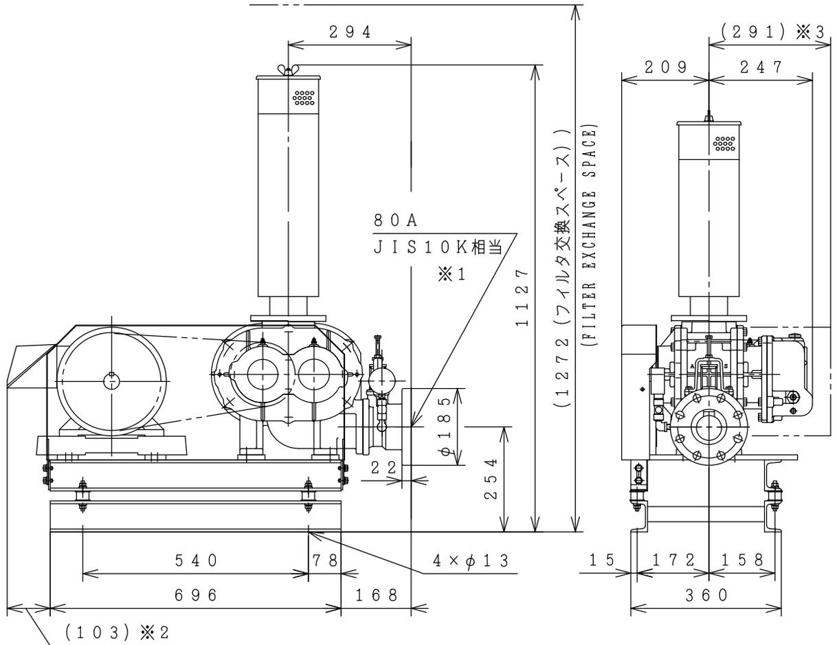
1. 吐出部フランジ (※1) の穴ピッチ、ボルト穴径はJIS10Kにあわせています。
