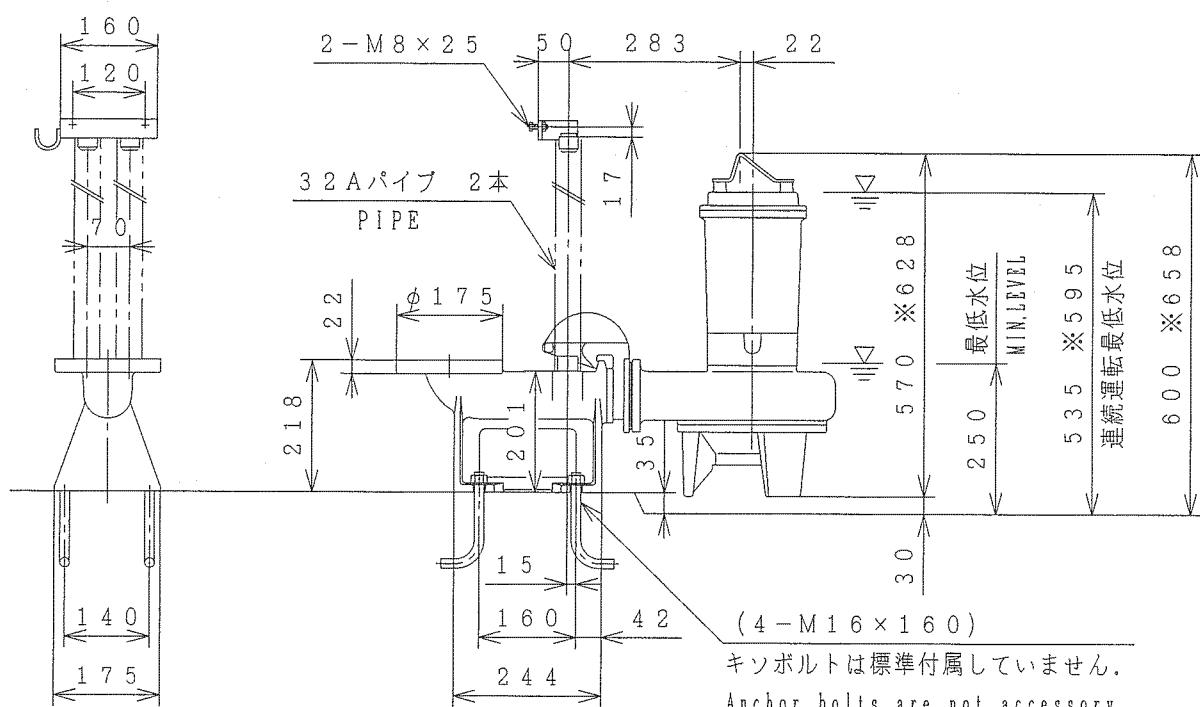
※は、M・T・P（マイクロサーマルプロテクタ）取り付け時の寸法です。
