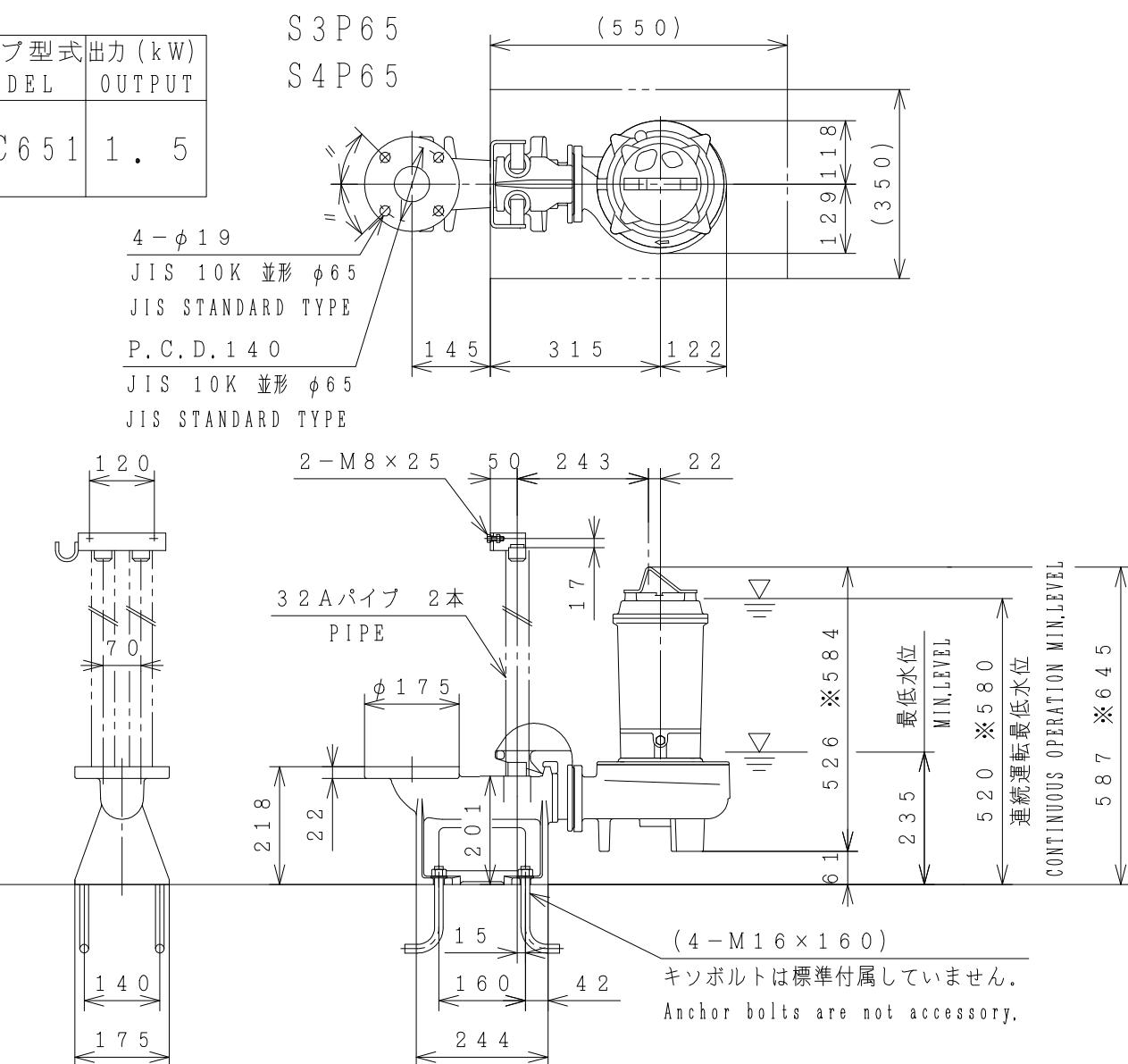
※は、M・T・P (マイクロサーマルプロテクタ) 取り付け時の寸法です。
